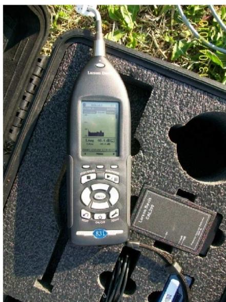
*Figura 5 – Fonometro integratore/analizzatore Real Time LARSON DAVIS modello 831*
