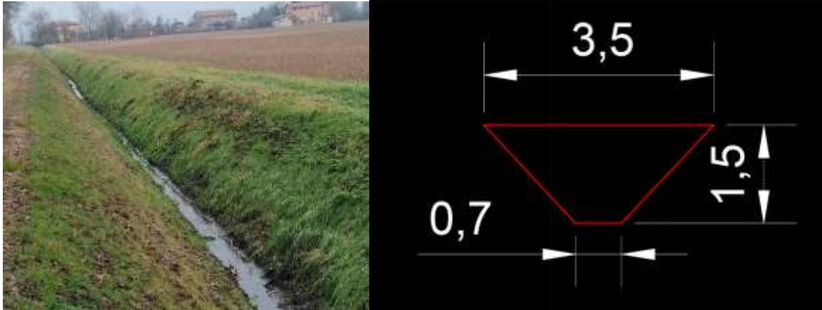
**Fig. 3.6.1** – Sezione del Cavo Fossetta delle Larghe in corrispondenza della chiusura del bacino considerato (misure in metri)
