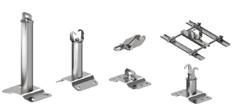
**Ancoraggio di Tipo D** - ancoraggio lineare (ancoraggio rigido): dispositivo di ancoraggio che utilizza una linea di ancoraggio rigida che devia dall'orizzontale non più di 15° (quando misurata tra l'estremità e gli ancoraggi intermedi a qualsiasi punto lungo la sua lunghezza).
